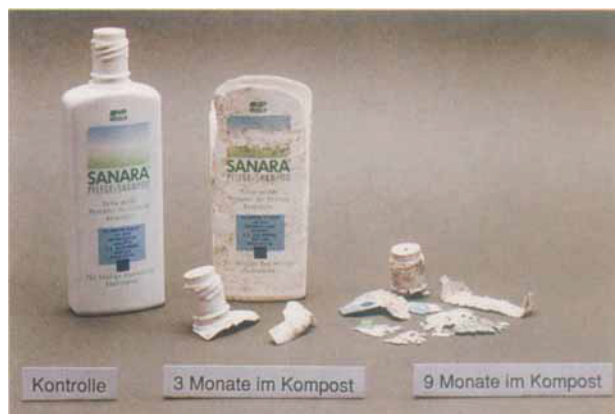
Abb. 4. Haarwaschmittelflaschen aus BIOPOL nach 0, 3 und 9 Monaten in Komposterde. Deutlich sichtbar ist der langsamere Abbau der bedruckten Teile. Wie Doi et al. zeigten [92b] , findet der Abbau von der Oberfläche her statt und verläuft umso schneller, je größer die Oberfläche wird. Die nicht-enzymatische Hydrolyse ist um einige Größenordnungen langsamer als die enzymatische Depolymerisation.
